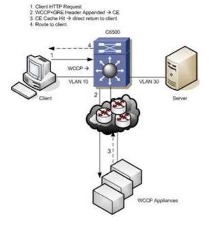
WCCP L3-Betrieb umfasst die Verwendung von GRE als Kapselungsmethode. Umgeleitete Pakete werden in einem GRE-Header mit dem Protokolltyp 0x883e gekapselt, zusammen mit einem 4-Byte-WCCP-Umleitungs-Header, der eine Dienst-ID und einen übereinstimmenden Hash-Bucket enthält (nur WCCPv2). Durch die Verwendung von GRE kann der WCCP-Client durch mehrere L3-Hops (geroutet) vom Catalyst 6500 getrennt werden.
