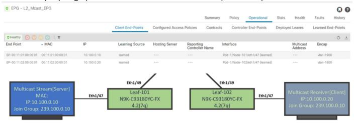
Schritt 4: Konfigurieren von IGMP Querier
