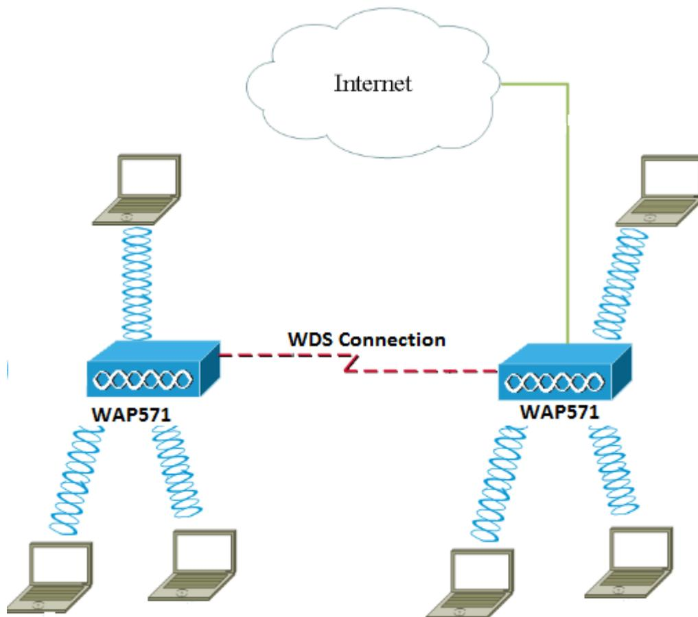
**Hinweis:** Bei Verwendung von WDS ist es möglich, dass der maximale Wireless-Durchsatz nach dem ersten Hop halbiert werden kann, da einer der WAPs in einem Paar die Informationen während der Kommunikation der beiden Seiten erneut übertragen muss.
