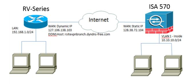
Ein standortübergreifender IPsec-VPN-Tunnel wird zwischen dem Cisco Router der RV-Serie in der Außenstelle und dem Cisco ISA der Serie 500 in der Hauptniederlassung konfiguriert und eingerichtet.
