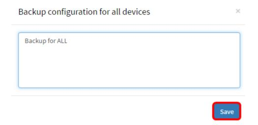
Die FindIT Network Probe kopiert dann die Konfiguration der einzelnen Geräte und speichert sie lokal in der Probe.
