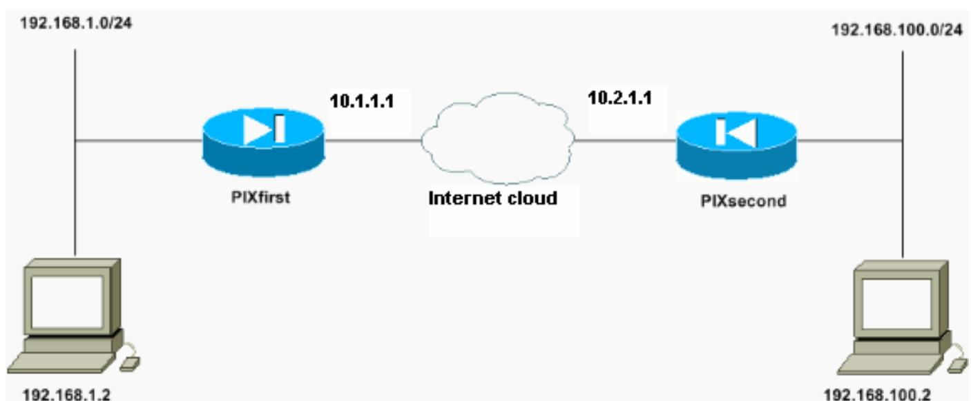
Der Host mit der IP-Adresse 192.168.100.2 wird in 192.168.50.2 auf der PIX-Firewall mit dem Hostnamen PIXfirst übersetzt. Diese Übersetzung ist für den Host und sein Ziel transparent.
