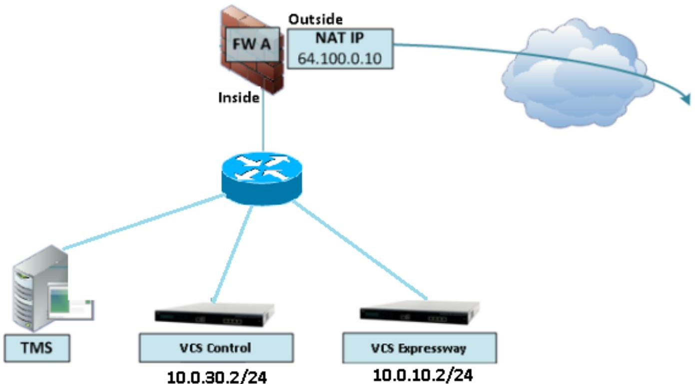
Für eine solche Implementierung muss die VCS Control IP-Adresse in die interne IP-Adresse der ASA übersetzt werden, damit der zurückkehrende Datenverkehr zur ASA zurückgeleitet wird, um Probleme mit asymmetrischen Routen für die NAT-Reflexion zu vermeiden.
