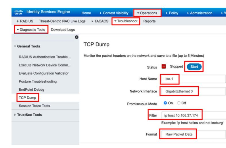
Um Datenverkehr zum Repository auszulösen, der getestet werden muss, navigieren Sie zu Administration > System > Maintenance > Repository, wählen Sie das Repository aus, und klicken Sie auf Validate. Navigieren Sie anschließend zu Operations > Troubleshoot > Diagnostic tools > TCP Dump, Klicken Sie auf Stop, und laden Sie die Paketerfassung herunter, wie im Bild dargestellt.
