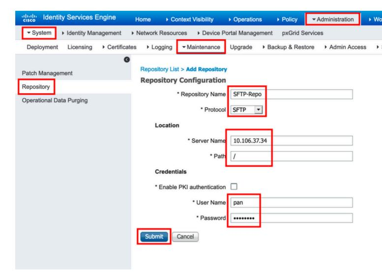
Schritt 3: Nach Abschluss von**lecken** Submit, a Eine Popup-Meldung wird angezeigt. In der Meldung werden Sie aufgefordert, den Hostschlüssel des SFTP-Servers mithilfe der CLI hinzuzufügen, wie im Bild gezeigt.
