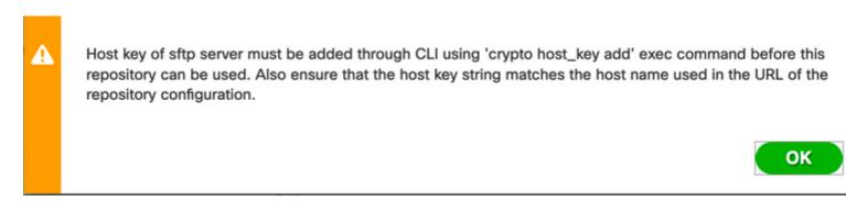
Schritt 4: Melden Sie sich über SSH bei der CLI des ISE-Knotens an, und verwenden Sie den Befehl crypto host\_key add host <ip address of the server> um den Hostschlüssel hinzuzufügen.
