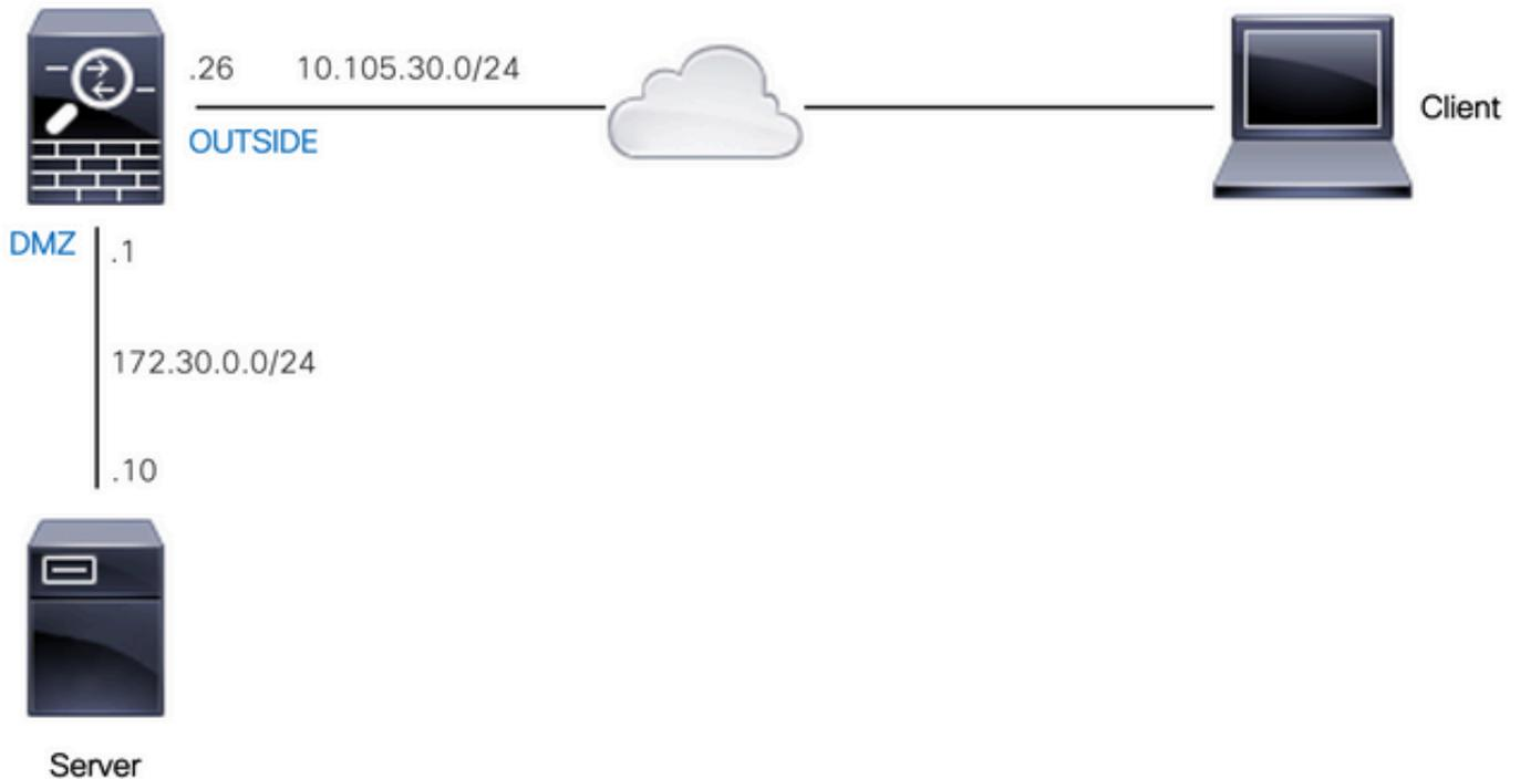
Die tatsächliche IP-Adresse des Webservers lautet 172.30.0.10. Eine statische One-to-One NAT-Regel wird konfiguriert, um Internetbenutzern den Zugriff auf den Webserver mit der übersetzten IP-Adresse 10.105.130.27 zu ermöglichen. Die ASA führt standardmäßig Proxy-ARP für 10.105.130.27 an der externen Schnittstelle durch, wenn eine statische NAT-Regel mit einer umgewandelten IP-Adresse konfiguriert wird, die in dasselbe Subnetz fällt wie die IP-Adresse der externen Schnittstelle 10.105.130.26:
