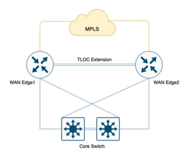
Wenn Sie über 100 Zweigstellen mit 2 Head Ends und eine vorgeschlagene Full-Mesh-Topologie zwischen Zweigstellen und Head Ends verfügen, können Sie die Voraussetzungen hierfür schaffen. Der Benutzer verfügt über einen strengen QoS-Standard mit einer Zuweisung von 20 % zu Low Latency Queue (LLQ) für Sprache.
