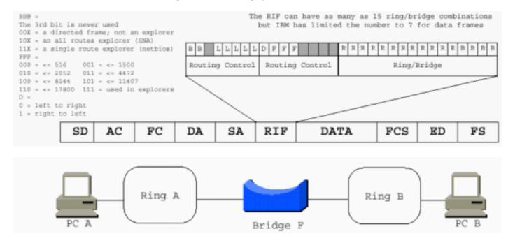
Beachten Sie, dass IBM im Hexadezimalformat arbeitet und der Quellroute-Pfad von PC A zu PC B 00AF.00B0 ist. Denken Sie daran, dass Sie den Binärausdruck der Ring-and-Bridge-Bits in den Hexadezimalausdruck konvertieren müssen, der bei der Arbeit mit SRB verwendet wird. Dieser
