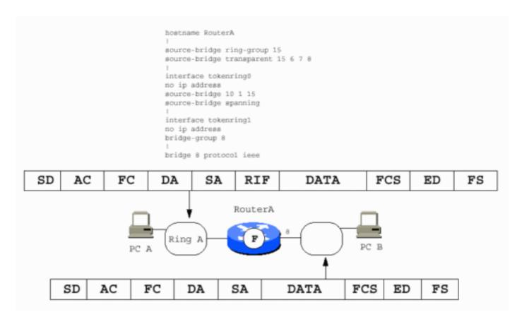
Für die Kommunikation mit einem Ethernet-PC ist bei einem SRB-PC auch die Lösung von Cisco erforderlich.
