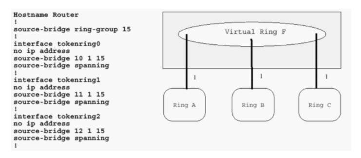
Dieses Diagramm zeigt einen Cisco Router mit zwei Token Ring-Schnittstellen. Dieser Router kann kein RSRB ausführen.
