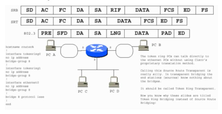
Stationen, die SRT verwenden, können nicht mit Stationen kommunizieren, auf denen SRB ausgeführt wird, wenn sie sich in separaten Ringen befinden. Die beiden Szenarien sind grundsätzlich unvereinbar. Ein SRT-PC benötigt die proprietäre Lösung von Cisco, um mit einem SRB-PC zu kommunizieren.
