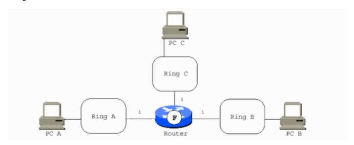
Wenn ein Cisco Router mit mehreren Ports die Zwei-Port-Bridge ersetzt, fungiert der Router als virtueller Ring zur Verbindung der echten Ringe. Es fügt den Token Ring-Schnittstellen Bridges hinzu. In den meisten Fällen können alle Bridge-Nummern 1 sein. Die Ausnahme sind parallele Bridges, die zwei Ringe verbinden. PC A an PC C ist jetzt 0810.00A1.00F1.00C0.
