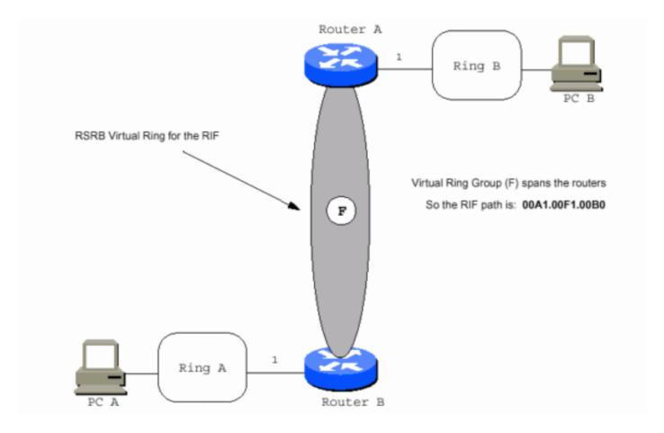
Der WAN-Typ ist nicht relevant, da der Token-Ring-Frame sicher in TCP/IP oder einfach IP verpackt ist, bevor er die WAN-Schnittstelle erreicht. Fast jeder LAN- oder WAN-Typ unterstützt Fast-Sequected Transport (FST)-Kapselung.
