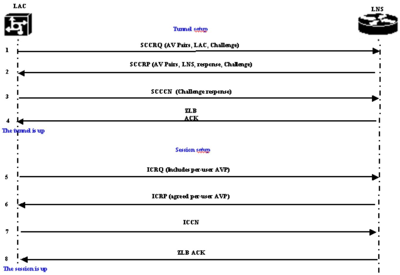
Die LAC entscheidet, dass ein Tunnel von der LAC zum LNS initiiert werden muss.
