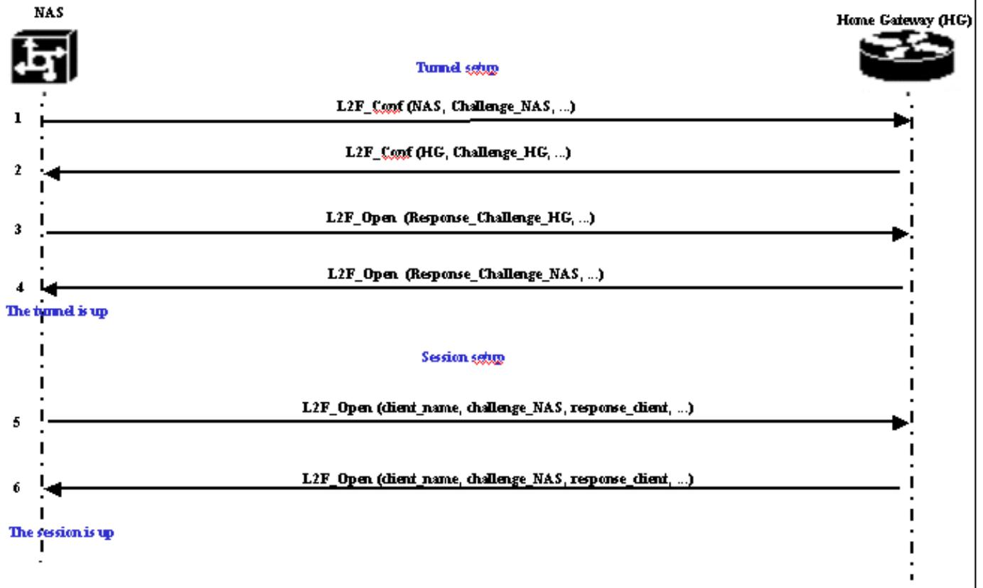
Das NAS entscheidet, dass ein Tunnel vom NAS zum Home Gateway initiiert werden muss.
