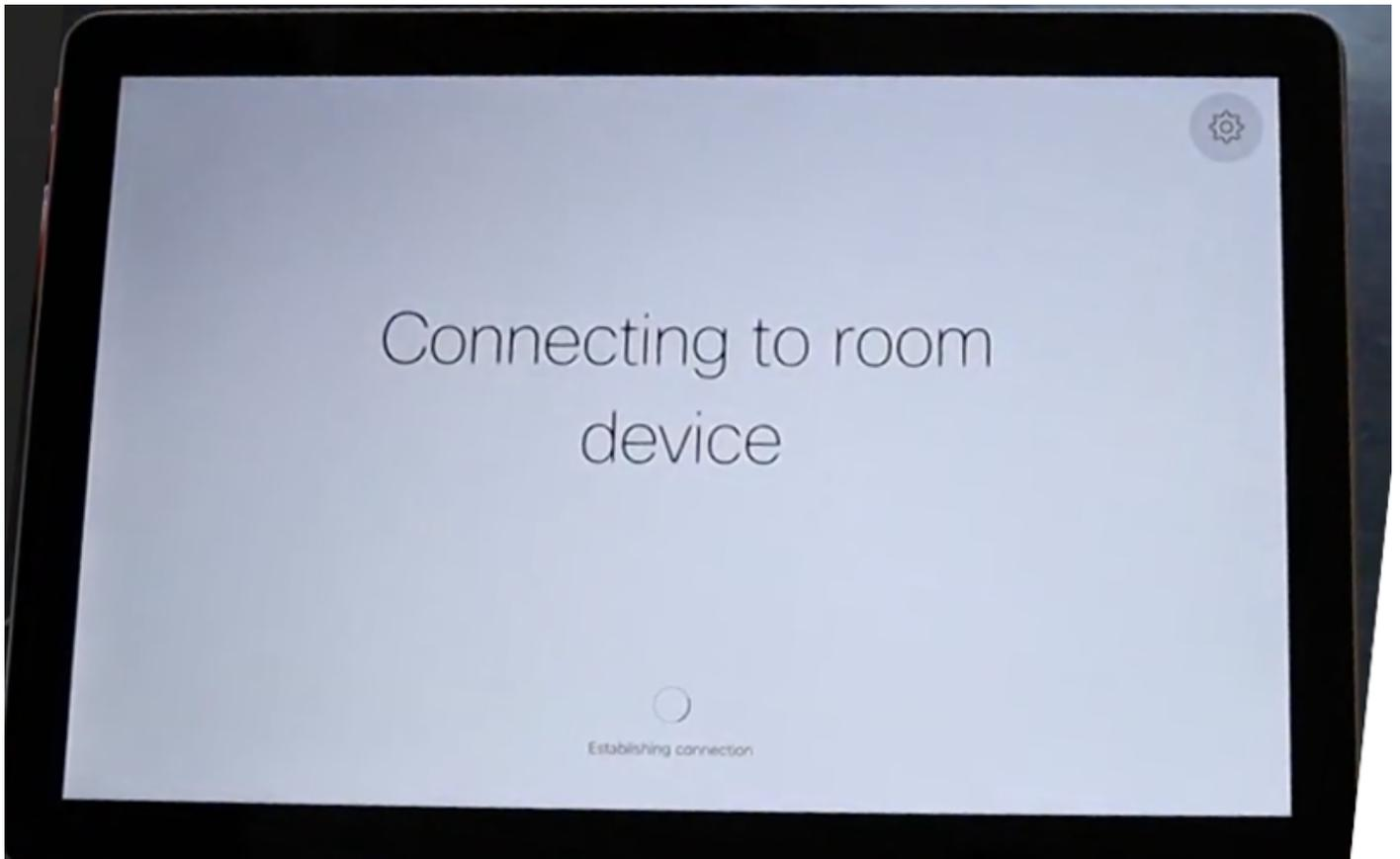
Wenn der WebEx Room Navigator das erste Mal gestartet wird, kontaktiert er das Raumgerät und lädt das Software-Image herunter.
