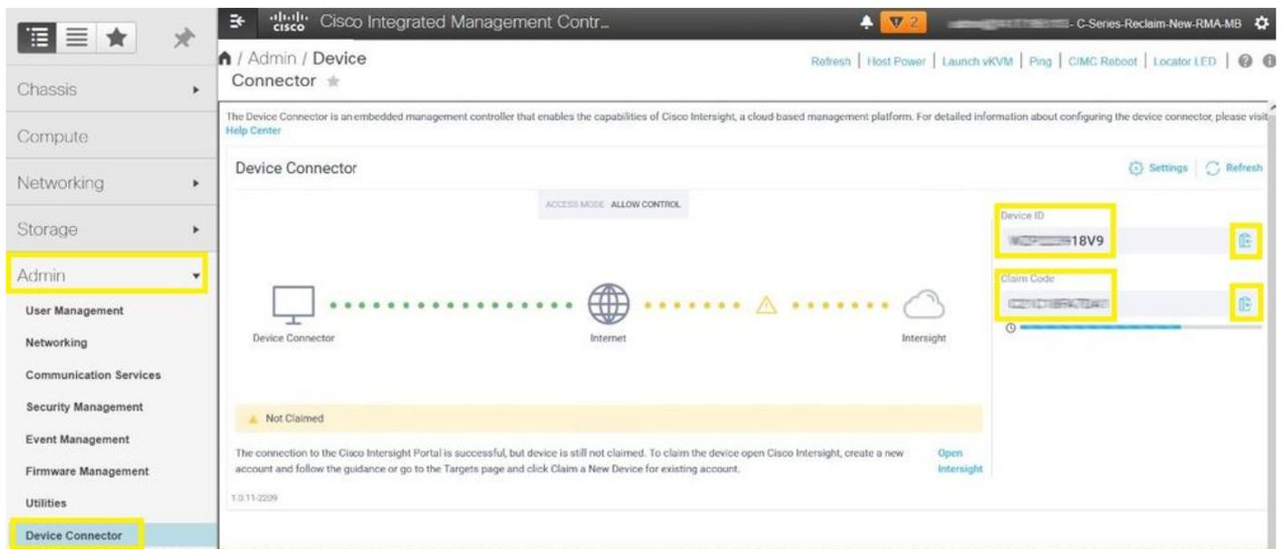
Schritt 5: Starten Sie Cisco Intersight, und navigieren Sie zu Admin > Targets > Claim a New Target > Cisco UCS Server (Standalone) > Start. Geben Sie Device ID und claim Code der aus der CIMC-GUI kopiert wurde, und wählen Sie claim.
