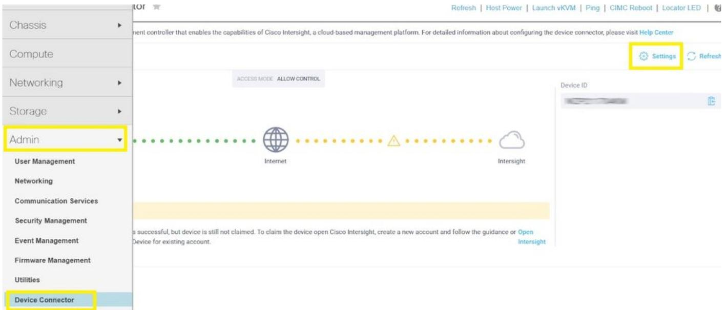
Schritt 3.1. Navigieren Sie zu **Admin > Device Connector > Settings > DNS Configuration** und die entsprechenden **DNS Server** und **save** wie in diesem Bild dargestellt.
