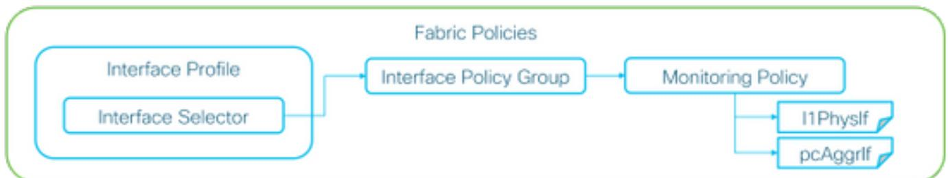
Jedem Port-Objekt (l1Physlf, pcAggrlf) kann wie im obigen Bild gezeigt eine eigene **Überwachungsrichtlinie** über die **Schnittstellenrichtliniengruppe** zugewiesen werden.
