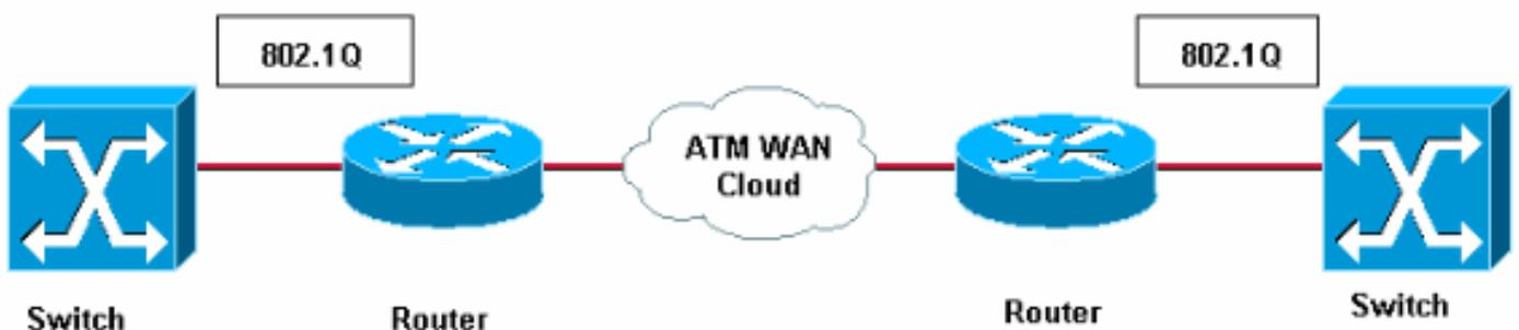
Es gibt jedoch eine andere Möglichkeit, End-to-End-VLANs zu erstellen. Konfigurieren Sie beide Router mit denselben Bridge-Gruppen und denselben 802.1Q-Subschnittstellen. Mit anderen Worten, die beiden Routerenden verfügen über eine 1:1-Zuordnung zwischen einer Bridge-Gruppe und einer 802.1Q-Subschnittstelle. Dies gilt nicht für den Cisco 7600.
