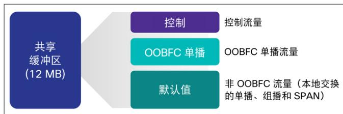
图 5. N9K-X9500 系列线卡上的 NFE 缓冲区信息显示
