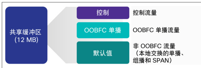
图 3. Cisco Nexus 9300 平台 NFE 缓冲区服务池
