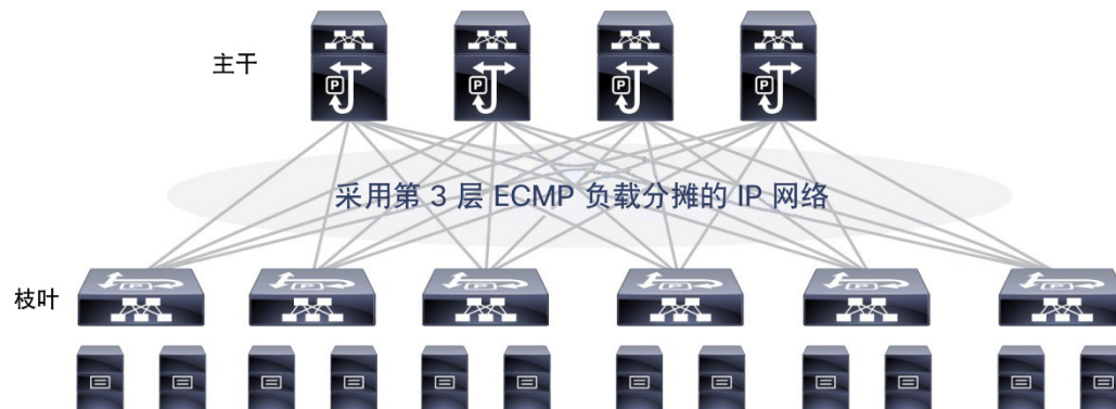
图 12. 两层的主干-枝叶交换矩阵架构
