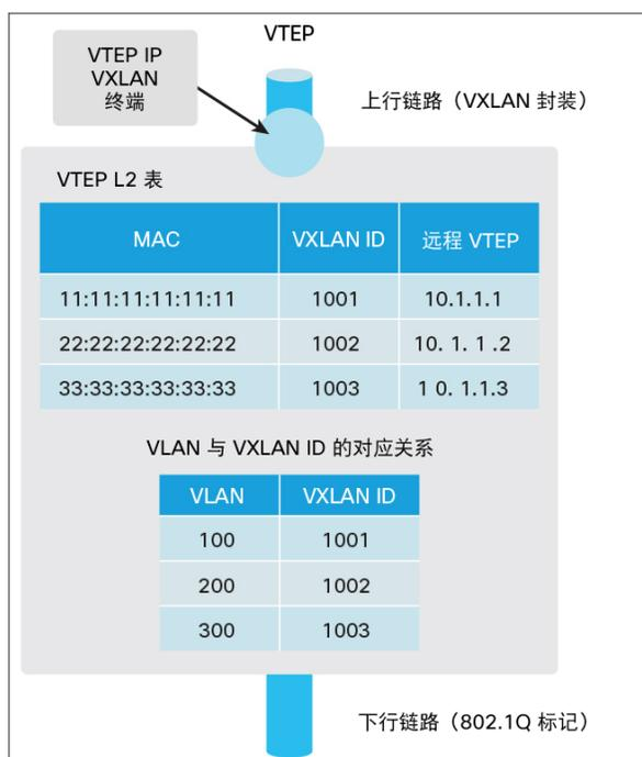
VXLAN 草案标准不要求为发现或学习使用控制协议。它为控制平面来源学习（推送模式）和基于中央目录的查找（拉取模式）提供建议。在撰写本文时，大多数实施依靠泛洪和学习机制来学习终端主机的可达性信息。在此模式中，VXLAN 在与原始 VTEP 相同的网段上建立至所有 VTEP 的一点对多点隧道，以便在交换矩阵中转发未知和多目标的流量。此转发通过关联每个网段的组播组完成，因此它要求底层交换矩阵支持 IP 组播路由。
