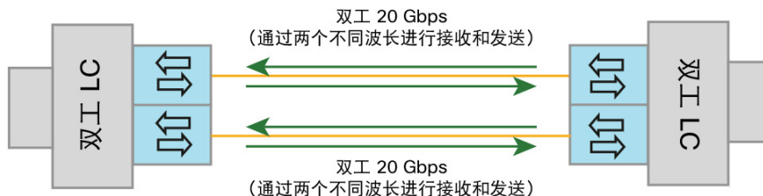
图 27. Cisco BiDi 光纤连接和速度
