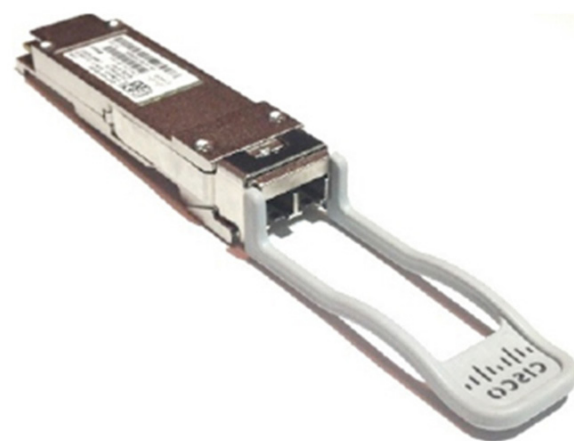
图 26. Cisco QSFP BiDi 收发器
