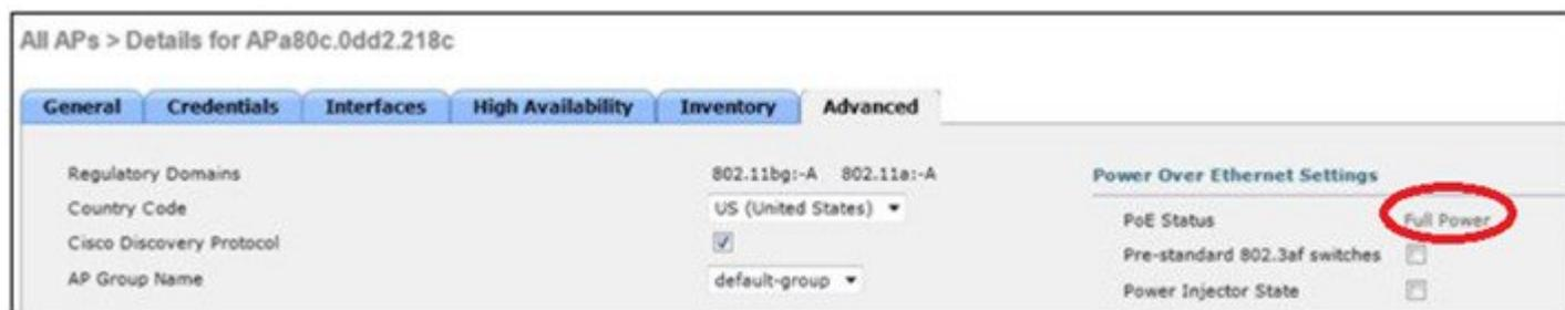
ただし、PoE スイッチ、ミッドスパン、またはインジェクタなどの電源装置がハイパワーを適切にネゴシエートできない場合、「ANY」モードとなり、デバイスが提供できる電力がすべて供給されます(15.4 W (802.3af) となる場合が多くなります)。
