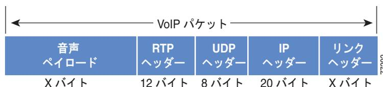
VoIP ストリームによって消費される帯域幅を計算するには、次に示すように、パケットのペイロードとすべてのヘッダーを加算し（ビット単位）、1 秒あたりのパケット レート（デフォルトでは、毎秒 50 パケット）を掛けます。
