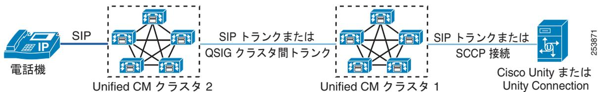
図 13-18 は、集中型ボイスメッセージングを使用する分散型コール処理環境でのクラスタ間トランク (H.323 または SIP) を介した eMWI を示しています。
