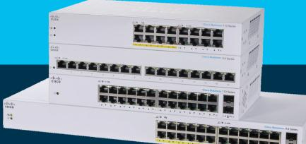
Cisco Business 110 シリーズ スイッチをご購入いただきありがとうございます。 本シリーズは電源を挿し込むだけ(設定不要)で L2 アンマネージド スイッチとしてご利用いただけます。 デフォルト設定では、電源がオンになると接続されているデバイス間でパケット転送が開始されます。
