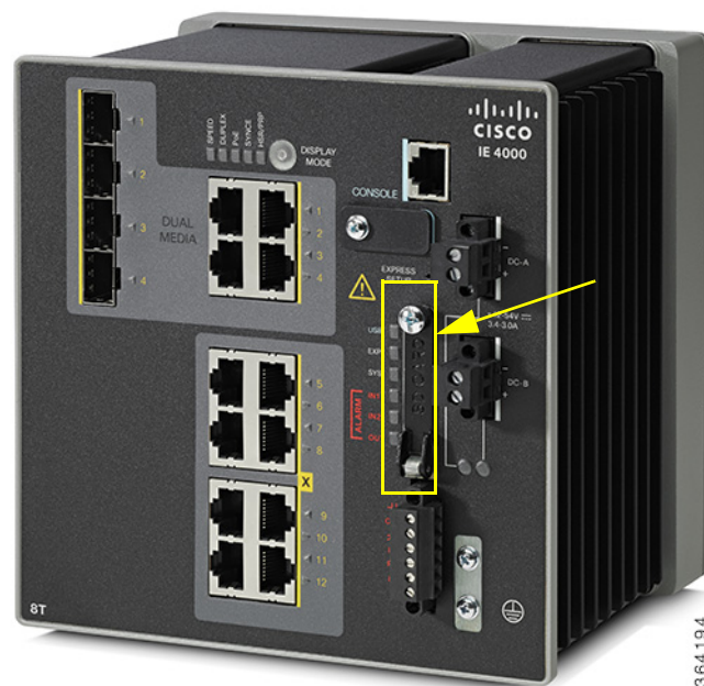
図 2-1 フラッシュメモリカードのスイッチへの取り付け
