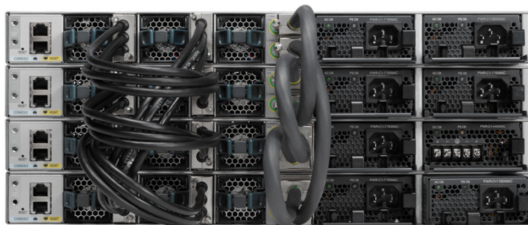
図 5 Cisco Catalyst 3850 StackWise-480 スイッチ スタックの背面図
