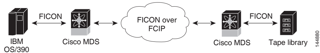
図 10-5 IBM/StorageTek (STK) ライブラリに直接アクセスするホスト
