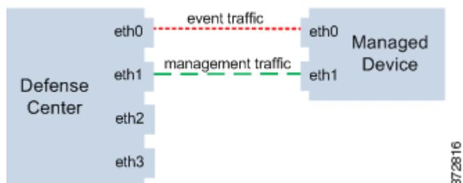
専用の管理インターフェイスを使用して、複数のデバイスからのイベントトラフィックのみを伝送することができます。この設定では、管理トラフィックチャンネルを伝送する別の管理インターフェイスに各デバイスを登録し、すべてのデバイスからのすべてのイベントトラフィックを、Defense Center上の1つの管理インターフェイスで伝送します。インターフェイスで障害が発生した場合は、トラフィックがアクティブインターフェイスに再ルーティングされるため、接続が維持されます。すべてのデバイスのイベントトラフィックが同じインターフェイスで伝送されることから、トラフィックはネットワーク間で分離されないことに注意してください。
