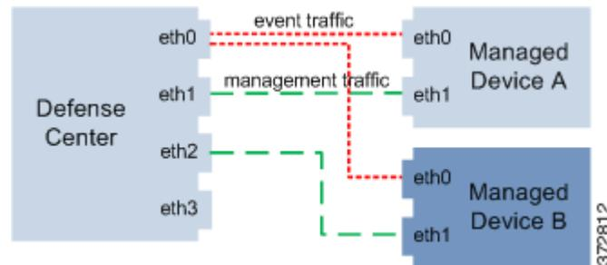
1つの管理インターフェイス上で2つのトラフィックチャンネルを使用する場合、Defense Centerと管理対象デバイスの上に2つの接続を作成します。同じインターフェイス上の2つのチャンネルのうちの一方が管理トラフィックを伝送し、もう一方がイベントトラフィックを伝送します。複数の管理インターフェイスを使用する場合は、トラフィックチャンネルを2つの管理インターフェイスに分けることができます。それによって両方のインターフェイスの容量が増し、トラフィックフローが増えるため、さらにパフォーマンスが向上します。一方のインターフェイスで管理トラフィックチャンネルを伝送し、もう一方のインターフェイスでイベントトラフィックチャンネルを伝送します。いずれかのインターフェイスで障害が発生した場合は、すべてのトラフィックがアクティブインターフェイスに再ルーティングされるため、接続が維持されます。
