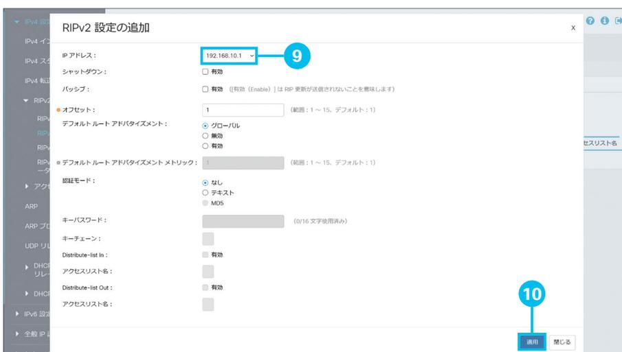
9 [IP アドレス] ドロップダウンリストで、RIPv2 を有効化したい VLAN の IP アドレスを選択
