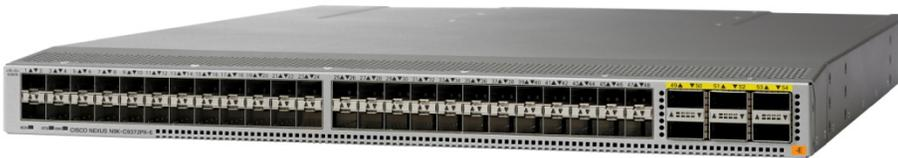
Cisco Nexus 9372TX および 9372TX-E スイッチは、1 RU のスイッチで、48 個の 10 Gbps 固定 BASE-T ポートと 6 個の 40 Gbps 固定 QSFP+ ポートのすべてにおいて 1.44 Tbps の帯域幅と 1150 mpps 以上の処理能力を実現しています (図 3)。Cisco Nexus 9372TX-E は、Cisco Nexus 9372TX のマイナー ハードウェア リビジョンです。NX-OS モードにおいてハードウェアの拡張が透過的で、機能の同等性を提供します。
