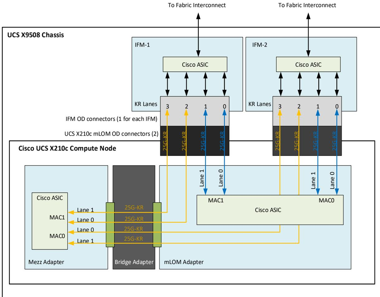
図7に、mLOM から 100G IFM へのネットワーク接続を示します。
