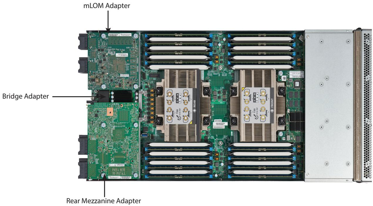
図 6 に、mLOM から 25 G IFM へのネットワーク接続を示します。
