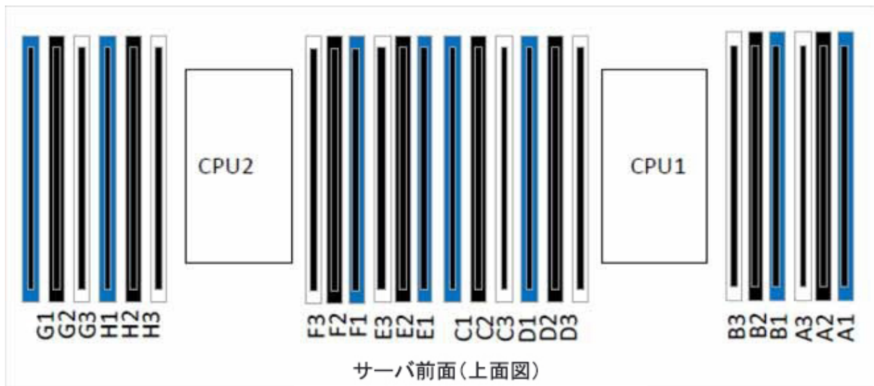
図 9 CPU DIMM チャンネルおよびスロットの物理レイアウト
