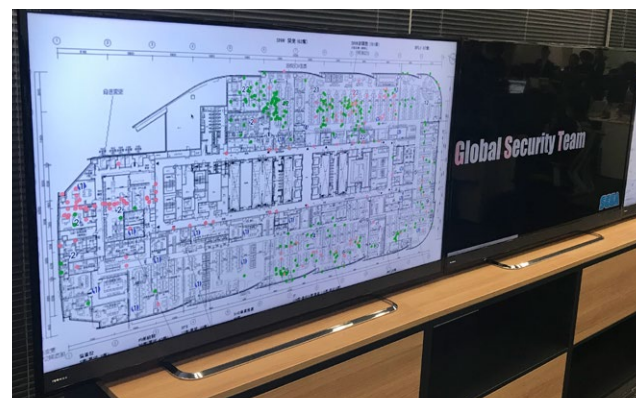
オフィス内に設置されたモニター。 Cisco CMX によりデバイスの密集状態が可視化されている。
