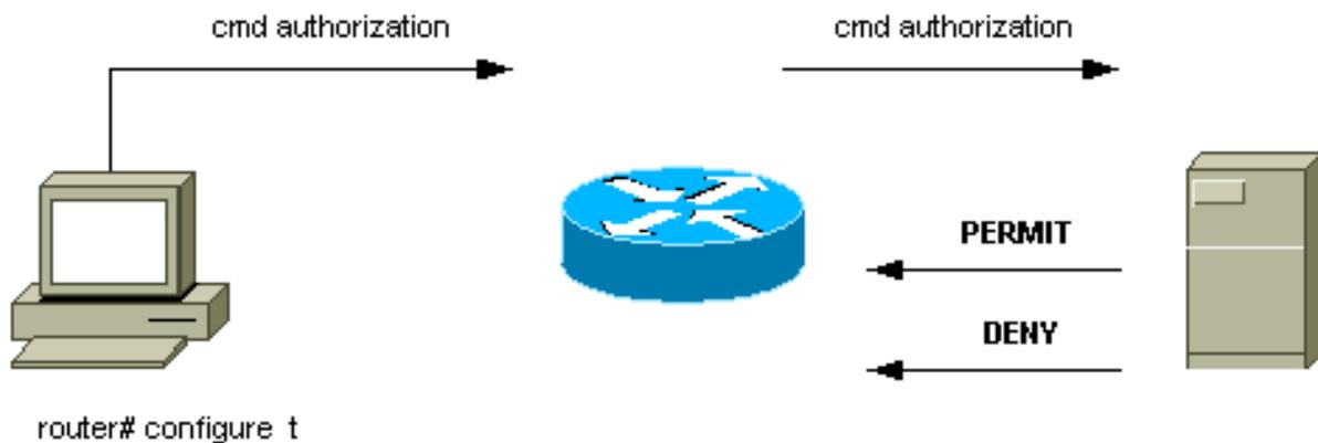
عندما يقوم المستخدم بالمصادقة على جهاز شبكة باستخدام TACACS+ في محاولة تسجيل دخول ASCII بسيطة، تحدث هذه العملية عادة:
