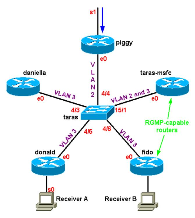
في هذه الحالة، فقط FIDO و Multilayer Switch Feature Card (MSFC) في تاراس هما موجهات قادرة على RGMP؛ دونالد، دانييلا، وبيغي ليست موجهات تدعم RGMP. يوجد مصدر متعدد البث 4.4.4.1 يرسل إلى 224.1.1.1 موجود على السلسلة خلف الخنزير. يقوم Taras-msfc بالتوجيه بين شبكة VLAN بين شبكة VLAN رقم 2 وشبكة VLAN رقم 3. لا يوجد مستقبل في شبكة VLAN 2 ولكن يوجد جهازان إستقبال في شبكة VLAN رقم 3: واحد خلف فيدو وواحد خلف دونالد.
